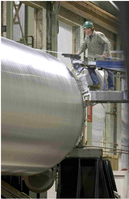
空气产品公司生产各种绕管式换热器的绕管工艺。
